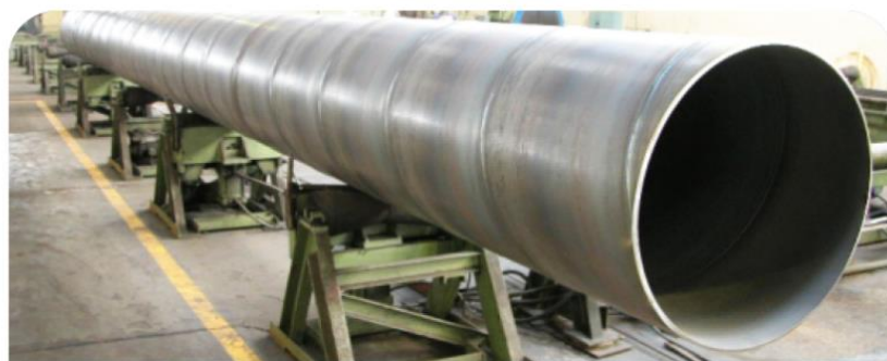
Tubos helicoidais em aço carbono ultrassonados
